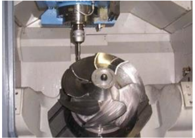
Water Jet Impeller ( \varnothing 600 mm)
